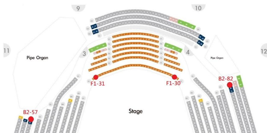
圖例 3.7.2- 歐規頭直通電力位置圖
