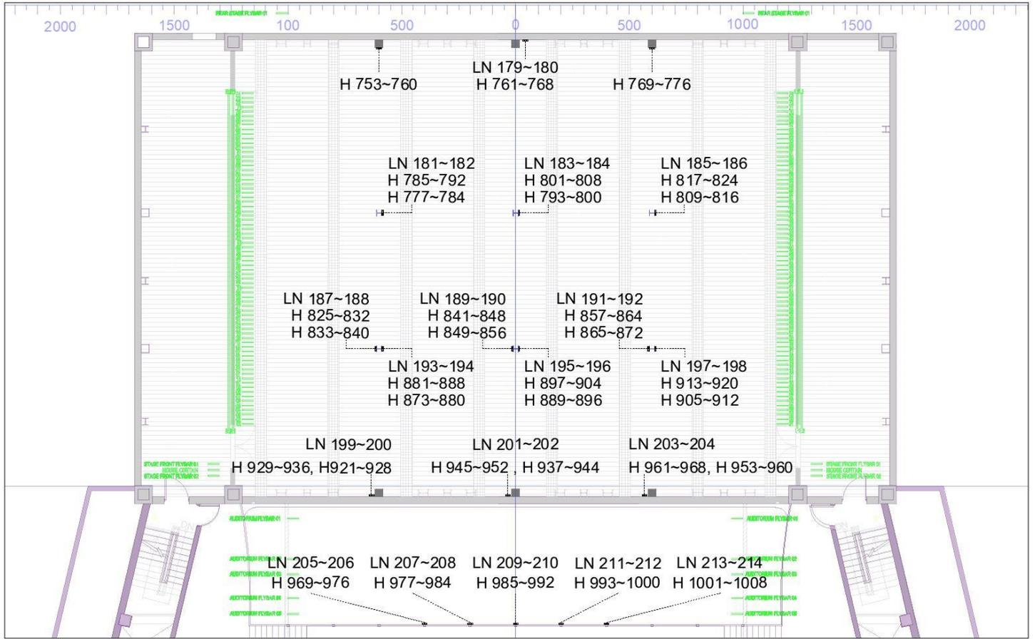
圖例 3.4.1.6- 頂棚(R1+R2)燈光迴路配置圖
