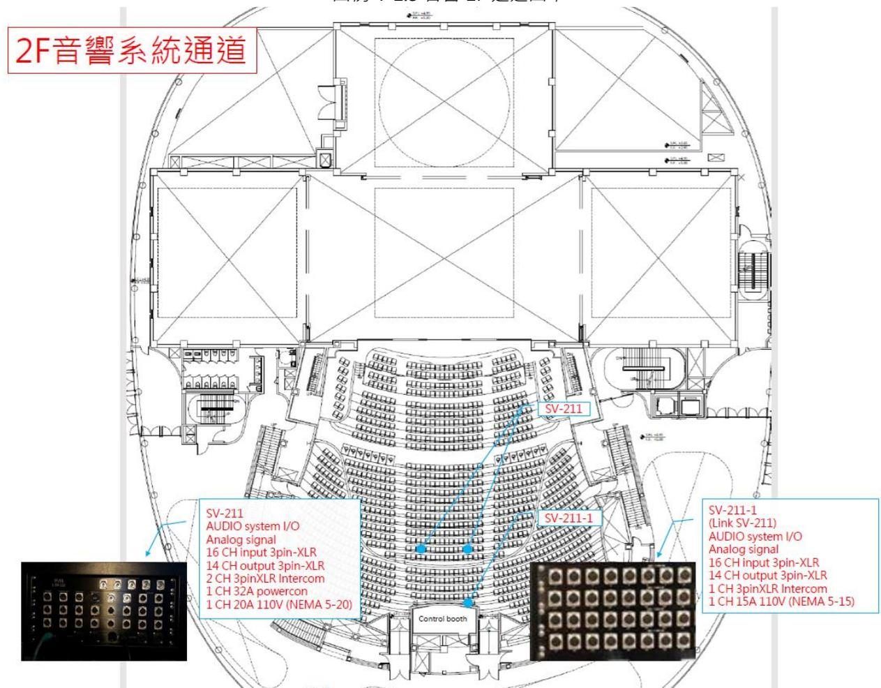
圖例 4-1.4 音響 2F 通道圖示
