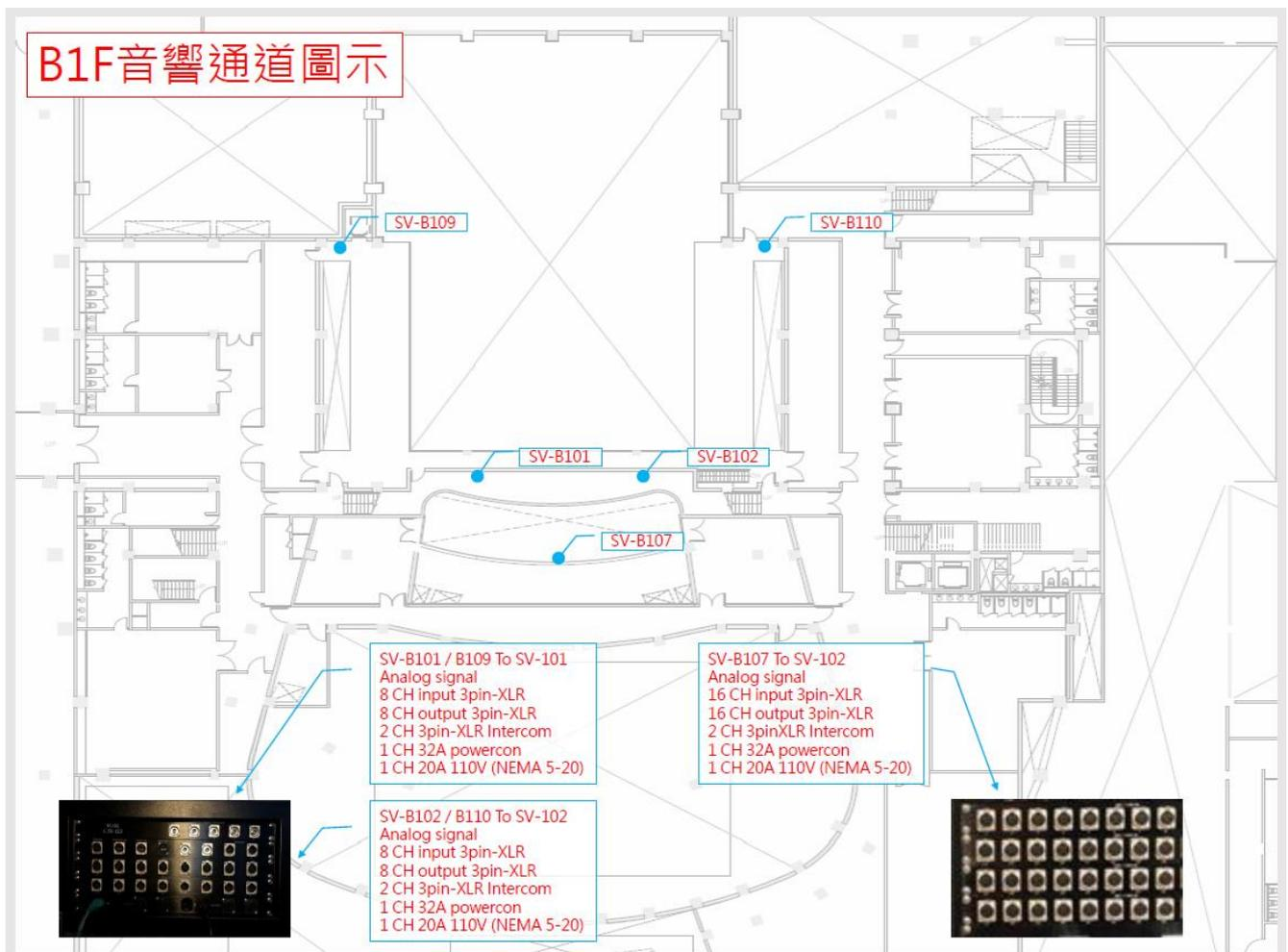
圖例 4-1.2 音響 B1F 通道圖示
