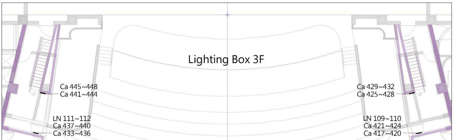
圖例 3.4.2.1- 燈光包廂燈光迴路配置圖
